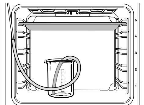
■ Stavite posudu sa sredstvom za uklanjanje kamena na dno pećnice.
