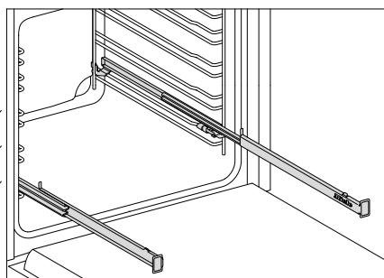
FlexiClip teleskopske vodilice mogu se ugraditi samo u razine 1, 2 i 3
